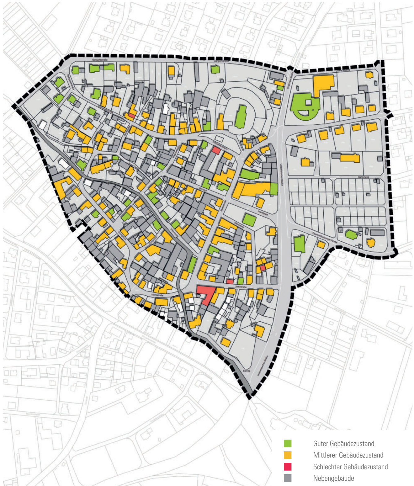
Gebäudezustand nach Augenschein, ohne Maßstab
